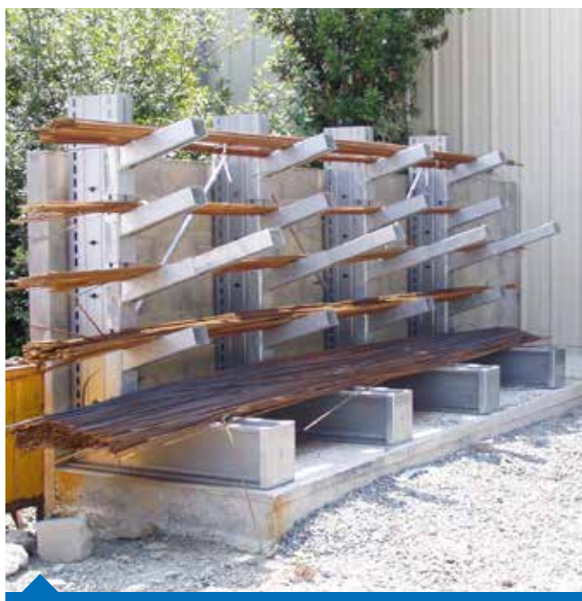
Bras à rallonges amovibles pour faciliter le stockage et le prélèvement des fers.
