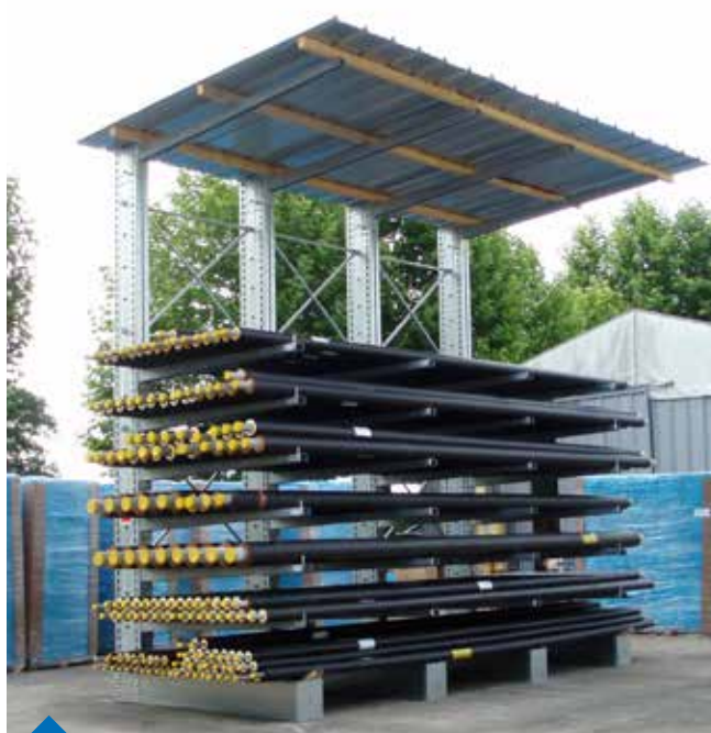
Stockage de charges très longues et rondes en extérieur avec butée en bout de bras pour éviter le chute.
