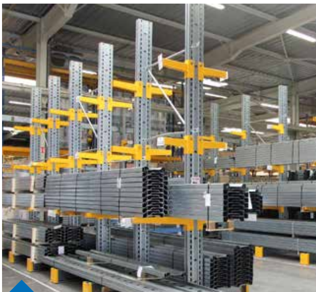
Stockage de profils d'acier ou aluminium sur bras de différentes longueurs.
