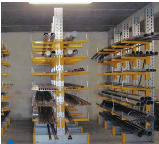
Stockage de tubes avec butée amovibles.
