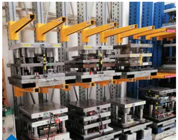
Stockage de moules d'emboutissage de pièces métalliques.
