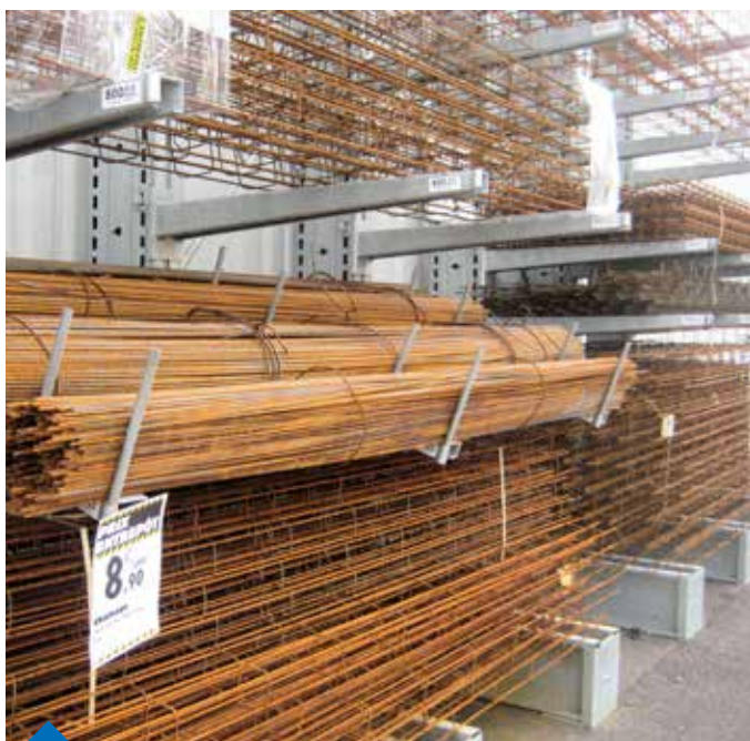
Fers chaînage stockés sur des bras avec trieurs.
