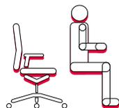
La hauteur d'assise est une condition impérative pour une bonne position assise. Le réglage de la hauteur d'assise permet d'augmenter l'amplitude de réglage définie par le EN 1335 pour un réglage correct de la hauteur d'assise selon la taille de l'utilisateur.
