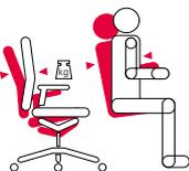
Grâce au réglage personnalisé de la tension, la position assise est adaptée en fonction du poids de l'utilisateur.
