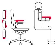
Réglage en hauteur pour soulager la musculature du cou et de la nuque. Réglage en largeur et orientation latérale pour obtenir un angle d'appui optimal, réglage en profondeur pour obtenir une distance idéale par rapport au plan de travail.
