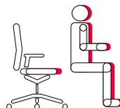
Règle la distance entre le dossier et le bord avant de l'assise et permet aux cuisses de reposer de façon optimale sur l'assise, quelle que soit la taille de l'utilisateur.
