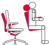
Grâce au mouvement synchrone de l'assise et du dossier, le corps est supporté de façon optimale dans chaque position.
