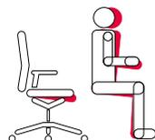
Le réglage à plusieurs niveaux de l'assise vers l'avant évite la bascule en arrière du bassin. Ceci permet de soulager la colonne vertébrale et d'éviter le dos rond pour un poste de travail bureautique particulier.
